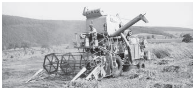
Der erste selbstfahrende Mähdrescher von CLAAS war 1953 der HERCULES, der später in SF umbenannt wurde.
