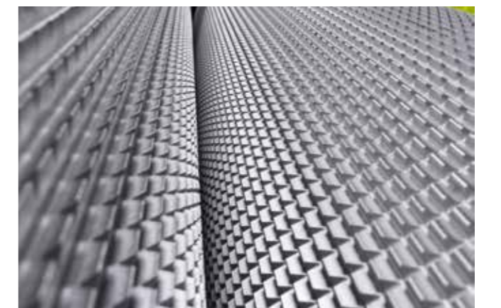
Die SHREDLAGE Technik zeichnet sich durch ein Walzenprofil mit 145 und 110 Sägezähnen aus.
