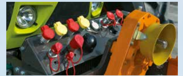
Die Hydraulikoptionen und die Elektrik sind zusammen an zentraler Stelle angebracht.
