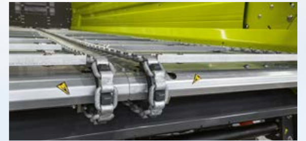
Der verzinkte Kratzboden mit robusten Flachgliederketten eignen sich auch für den Hackschnitzeltransport.
