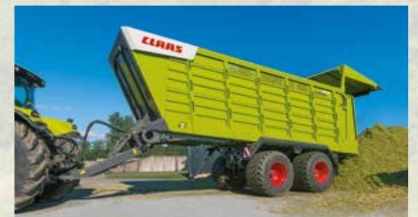
Zum schnellen Entladen lässt sich die Knickdeichsel anheben.
