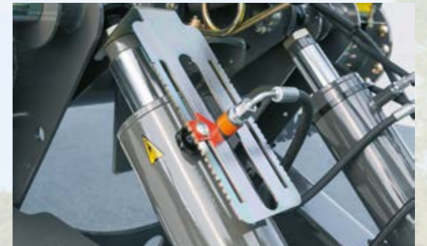
Der CARGOS 700 verfügt über eine serienmäßige Knickdeichsel mit hoher Hubkraft.
