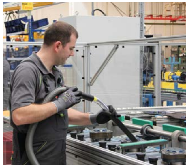
Die Qualitätsansprüche sind hoch. Verschmutzungen der Bauteile werden auf ein Minimum reduziert.
