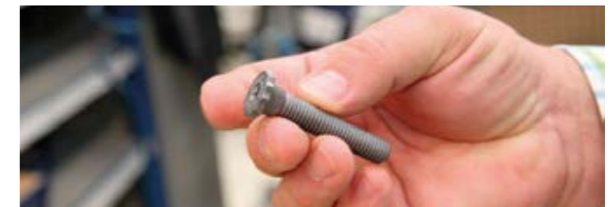
Um Schwachstellen durch Schweißnähte zu vermeiden, wird der MAX CUT Mähbalken geschraubt.
