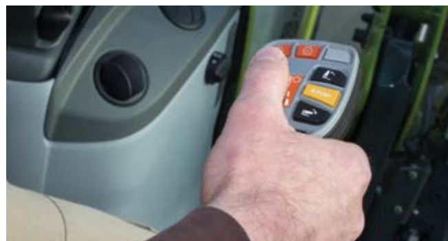
Schaltung und Frontlader liegen auf dem Multifunktionshebel.
