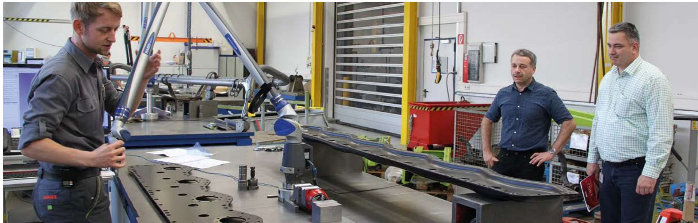
In einem Messraum überprüft ein Mitarbeiter, ob die Vorgaben von den Zulieferern eingehalten wurden. Für Martin Ober (Mitte) und Frank Bachmann (rechts) spielt Reinheit in diesem Bereich eine große Rolle.
