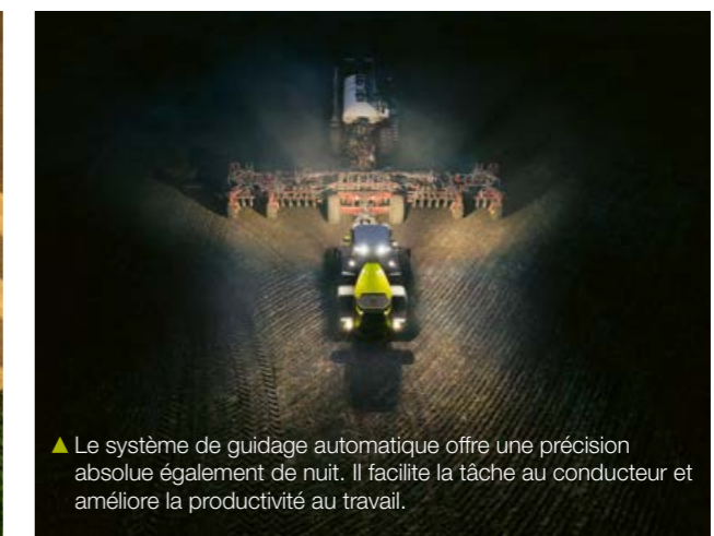
▲ Travail du sol avec l'AXION 800. Équipement numérique : GPS PILOT CEMIS 1200 en mode A-B-Contour et CEMOS.
