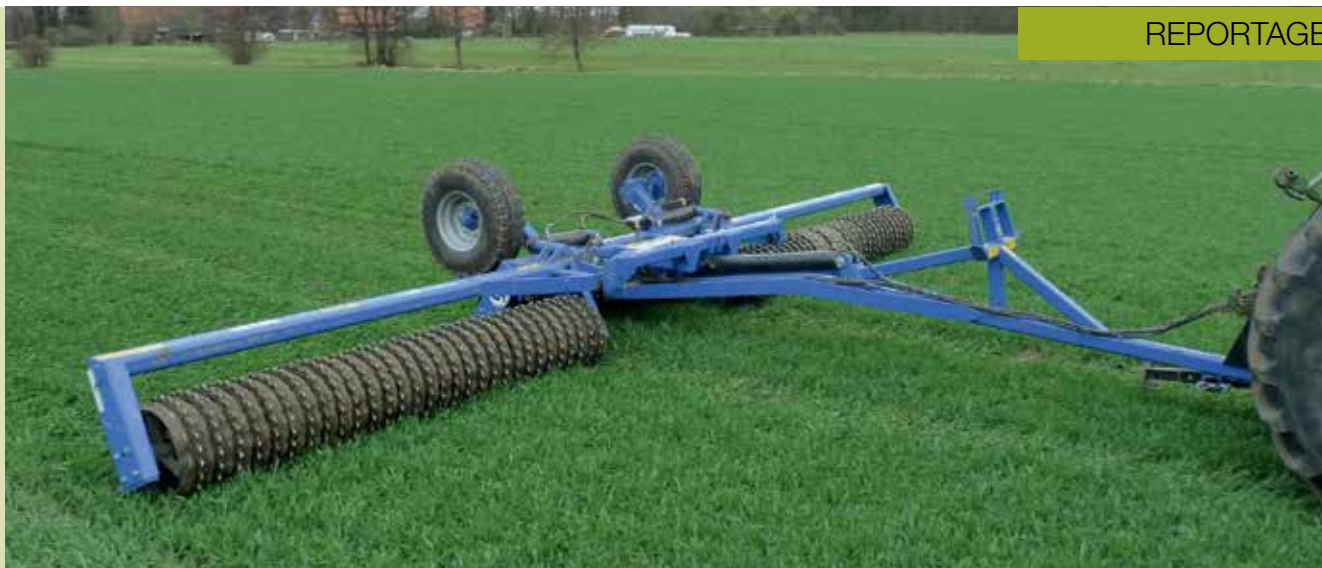
Das Unternehmen setzt auf dem Grünland die Cambridgewalze ein. Unter anderem wegen der im Vergleich zur Glattwalze größeren Arbeitsbreite.
