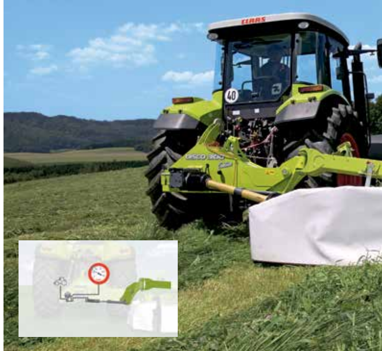
ACTIVE FLOAT beim DISCO Heckanbau verringert die Seitenzugkräfte.
