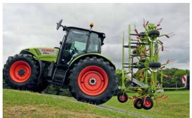
Die kompakte Bauart des VOLTO 1100 ermöglicht auch den Anbau an mittleren 4-Zylindertraktoren.
