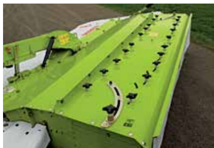
Streuschaufeln für Breitverteilung weit geöffnet.
