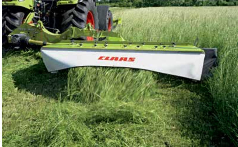
Falsch eingestellte Streuschaufeln – das Futter wird nicht breit genug abgelegt.
