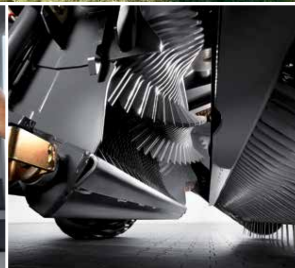
Der Schneidboden PRO ist hydraulisch gefedert.
