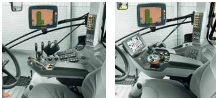
CIS (links) ist die klassische Basisversion mit kleinerem CIS Bordcomputer und mechanischen Steuerger ten sowie Bedienung der 24x24 HEXASHIFT Gangschaltung  ber einen Drivestick. Rechts die CEBIS Ausstattung mit dem CEBIS Terminal, elektrischen Steuerger ten und Gangschaltung  ber CMOTION Multifunktionshebel.
