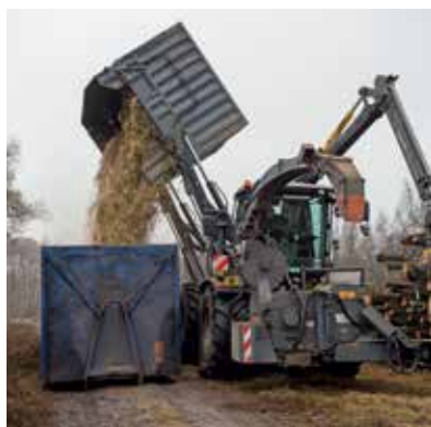
Bild rechts: Das Anheben und Entleeren des Kippbunkers dauert kaum zwei Minuten.
