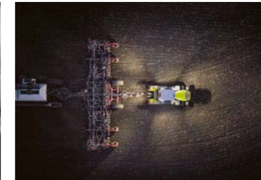
◀ Avec jusqu'à 22 phares de travail à LED, le pack d'éclairage longue portée éclaire à 360° votre périmètre de travail avec une intensité de 53 400 lm et se prête à toutes les applications.
