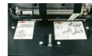
Un schéma de graissage est disponible sous le capot moteur pour faciliter la maintenance.
