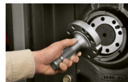
Embout de prise de force facilement interchangeable.
