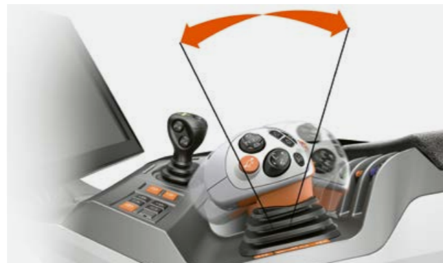
Commande progressive grâce à la technologie de transmission à variation continue CMATIC.
