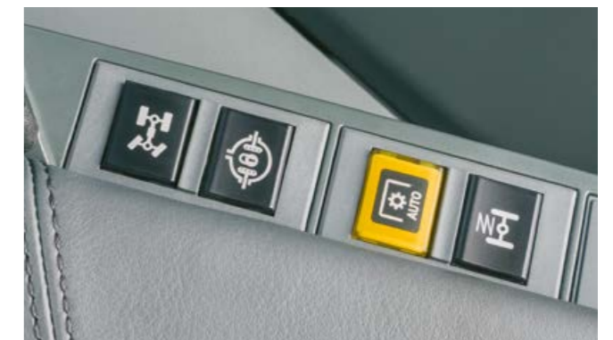
Activation de la suspension du pont avant.
