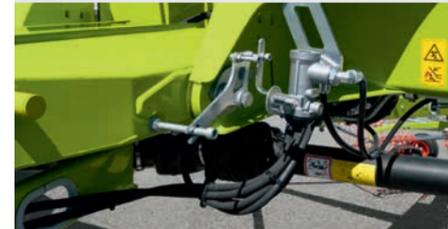
Das Bremsventil schaltet rein mechanisch, aber automatisch.
