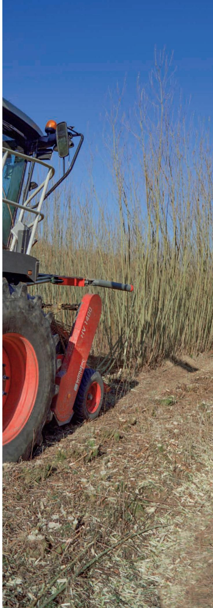
Nach dem Absägen durch 2 gegenläufige Kreissägeblätter werden die Stämme von Mitnehmersternen sowie den beiden vertikal angeordneten Einzugsstummeln erfasst und anschließend durch 4 liegend angeordnete Einzugsrollen in den Einzug des Feldhäckslers gefördert.
