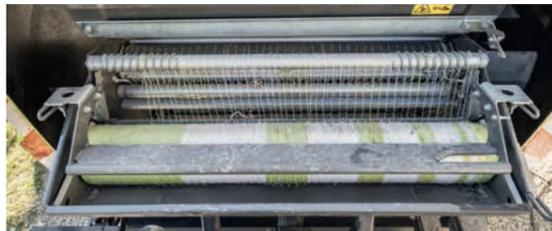
An allen VARIANT Pressen der 400er Baureihe ist eine **XW- (Extra-Wide)-Bindung** verbaut. Damit ist es möglich, das Netz an den Ballenkanten überlappen zu lassen.
