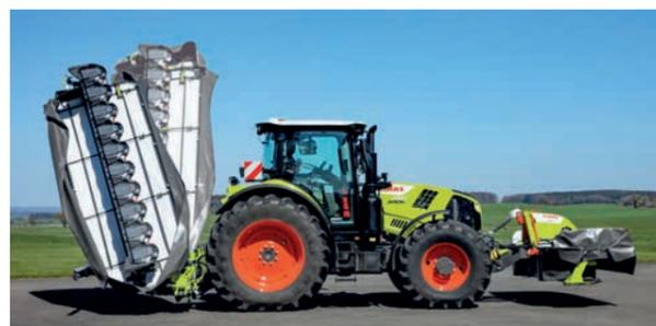
↑ Beim Wechsel in die Transportstellung wird das DISCO 4400 zunächst um 120 Grad in die Vertikale geklappt und danach um 17 Grad leicht nach hinten verschwenkt.
