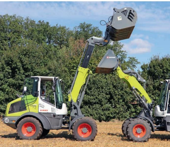
Der Hinterwagen ist gleich. Erst vor der Kabine wird der Radlader TORION zum Teleskopradlader mit dem Zusatz „T“ in der Modellbezeichnung. Der Arm reicht nicht so weit wie bei reinen Teleskopladern. Trotzdem machen die rund 1,80 m mehr Hubhöhe das Beladen von hohen Anhängern einfacher.
