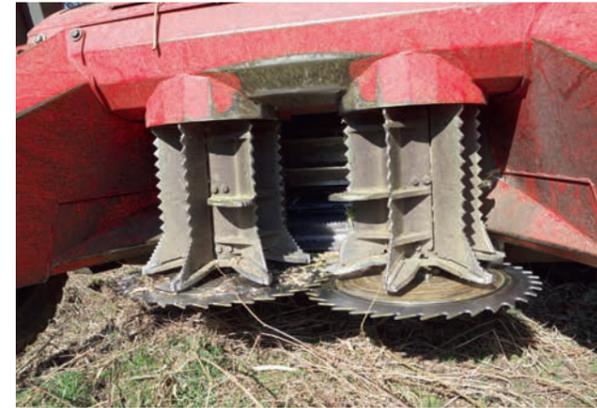
Bei Fahrgeschwindigkeiten um die 5 km/h können Stämme bis 120 mm Durchmesser problemlos geerntet werden. Flächenleistungen von bis zu einem Hektar pro Stunde sind unter optimalen Bedingungen möglich.
