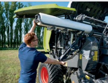
Zum Einlegen der Mantelfolie ist eine verstärkte Variante der Netzrutsche notwendig.
