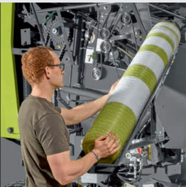
Die Netzrollenrutsche vereinfacht den Rollentausch.
