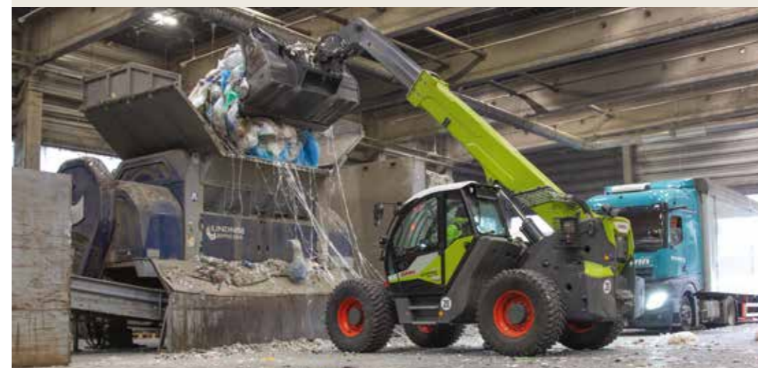
In der Aufbereitungsanlage erfolgen die Entfernung von Störstoffen und eine Zerkleinerung des Materials.
