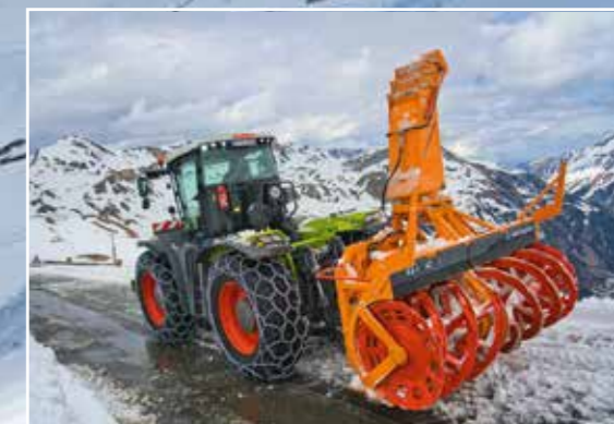
Ausgerüstet mit Schneeketten und einer Zwei-Meter-Fräse half der XERION mehr als 800.000 m 3 Schnee zu beseitigen.
