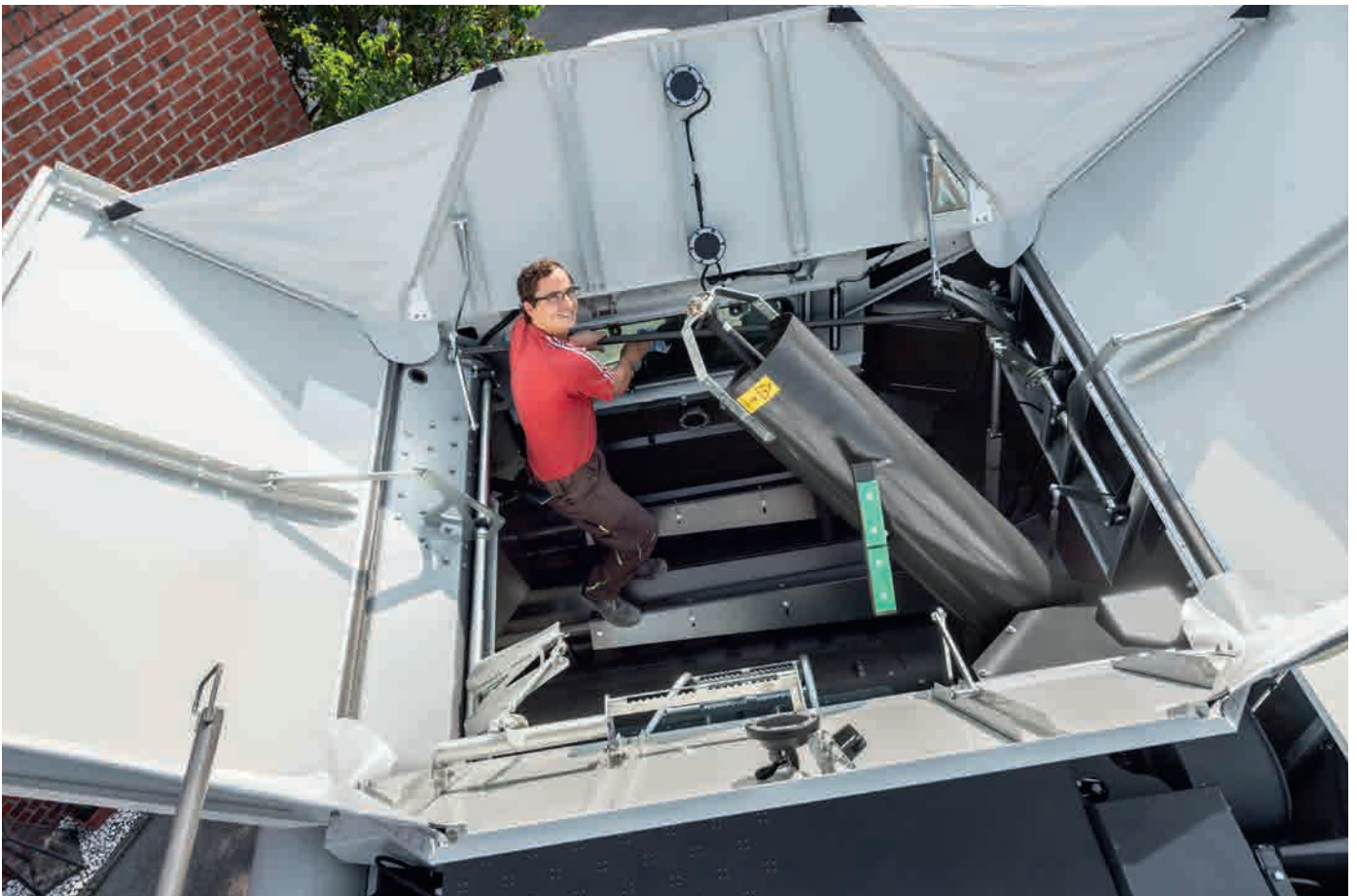
Rutschfeste Stufen und eine Reling erleichtern den Zugang zum Korntank.
