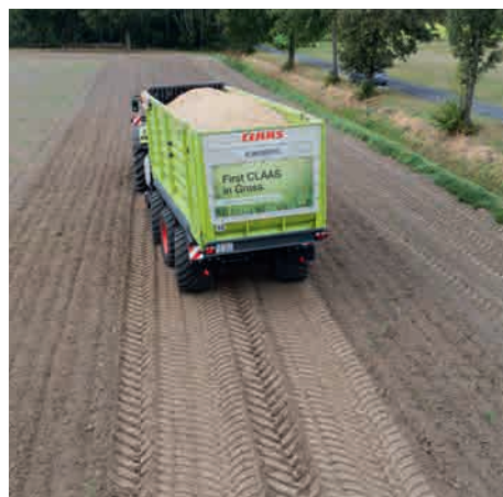
Beim Fahren im Hundegang ist die Tiefenwirkung des Bodendrucks geringer.
