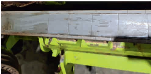
Die Einsatzleistung der vorderen Hartmetallkante (Richtung Einzug) liegt bei 600 ha Mais und 2.280 ha Gras. Sie bleibt weiterhin im Einsatz.
