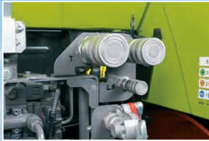
Die Leistung des Hydrauliksystems wurde auf 150 l/min gesteigert.
