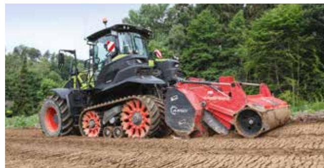
Trotz tiefgründig lockerer Struktur sackt die Maschine durch das TERRA TRAC Laufwerk kaum in den Boden ein.
