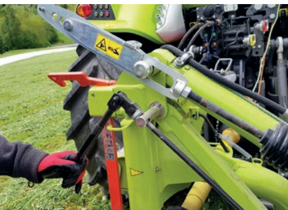
Der Mähbalken des seitlich angebauten Heckmähers Disco 3150 wird mit zwei Feder entlastet.
