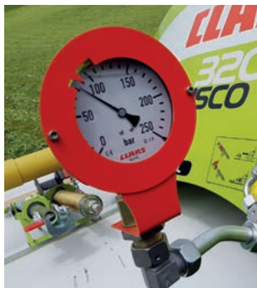
Beim Frontmäher Disco 3200 F Profil lässt sich der Balkenaufgelegedruck optional hydropneumatisch verstellen.
