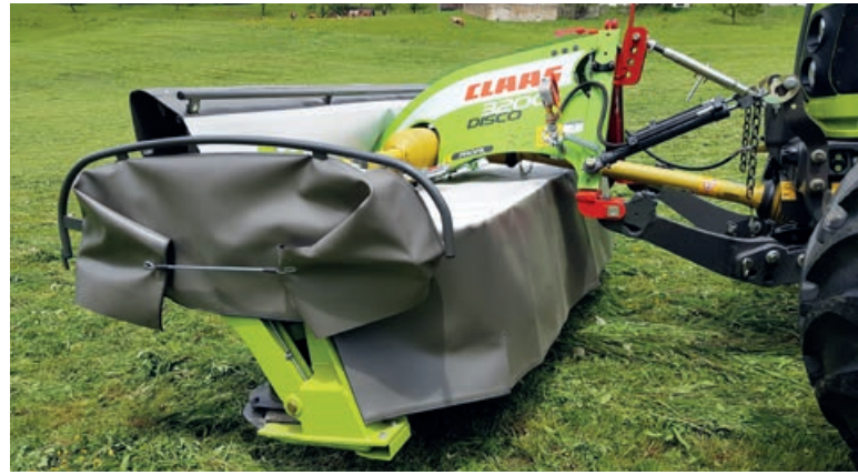
Der Mähbalken ist knapp über dem Boden frei drehbar gelagert (siehe Pfeil) und kann daher den Bodenkonturen gut folgen.
