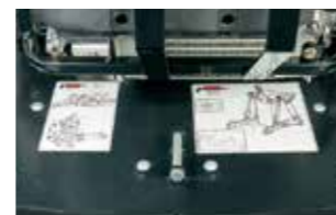
Un schéma de lubrification est disponible sous le capot moteur pour faciliter la maintenance.
