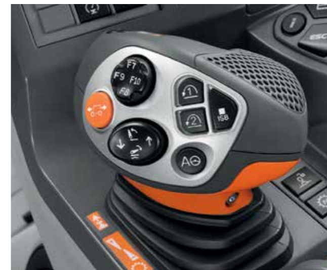
Inverseur droit sur la poignée CMOTION.
