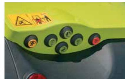
Commandes externes pour la prise de force arrière sur les deux ailes.
