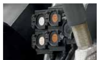
Lorsqu'un relevage avant est installé, deux vannes hydrauliques et une conduite de retour à écoulement libre sont disponibles à l'avant. Idéal pour les équipements montés à l'avant.
