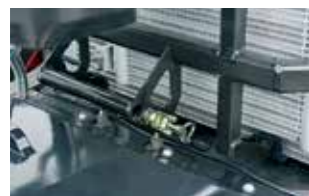
Les points de lubrification du pont avant sont situés devant le radiateur pour une accessibilité optimale.
