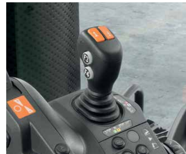
Inverseur droit en option sur la manette ELECTROPILOT.
