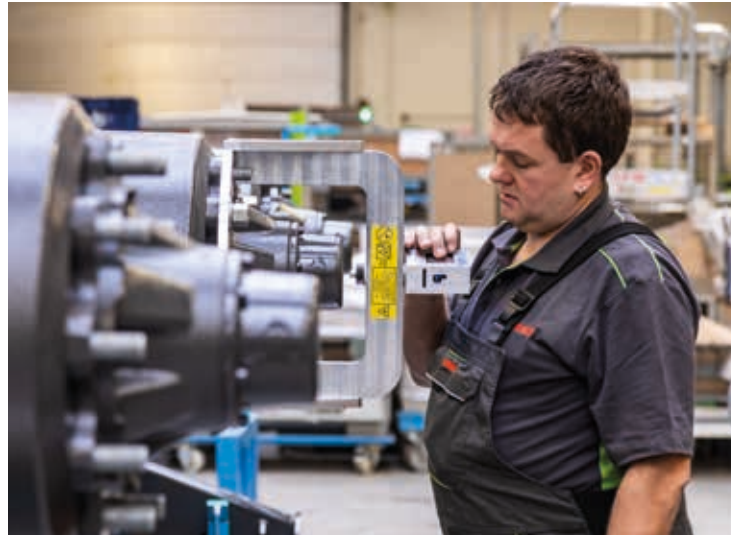
Damit der CARGOS sauber in der Flucht läuft, vermisst Stefan Mayer die Achsböcke wie in der Automobilindustrie mittels Laser.
