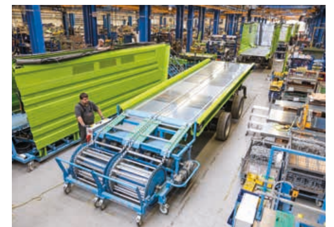
An dieser Station erhält der Wagen seinen Boden und die Deichsel. Mit einer Spezialvorrichtung werden die vorgefertigten Kratzbodenketten schnell und einfach eingezogen.
