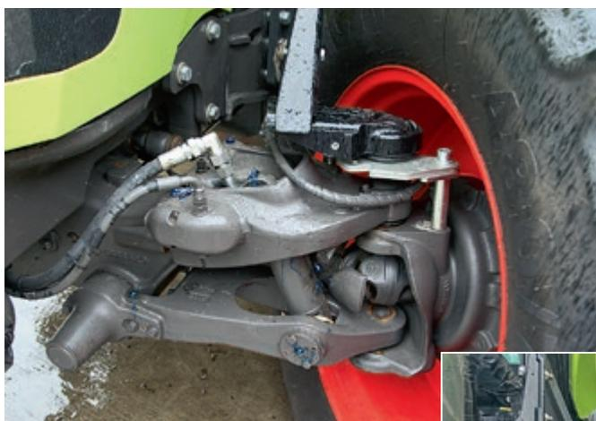
Die gefederte Carraro-Achse funktioniert super, sollte wegen der vielen Nippel aber eine Zentralschmierung haben. 2017 kam die wartungsärmere Vorderachsfederung von Dana (Bild unten).
