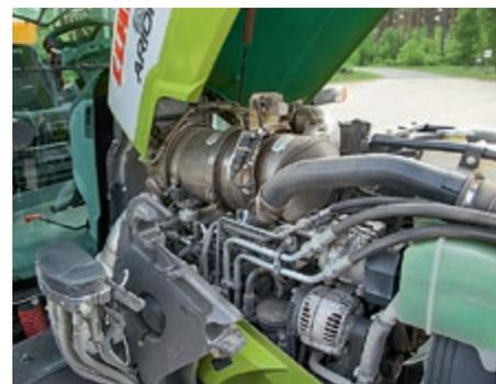
Abgasstufe IIIB mit Diesel-Oxidations-Katalysator (DOC) und Dieselpartikelfilter (DPF), aber eben noch ohne SCR-Katalysator und damit auch ohne AdBlue. Das „erkaufte“ man sich mit einem höheren Anteil bei der Abgasrückführung, was offensichtlich auch der Grund dafür war, dass die Arion dieser
