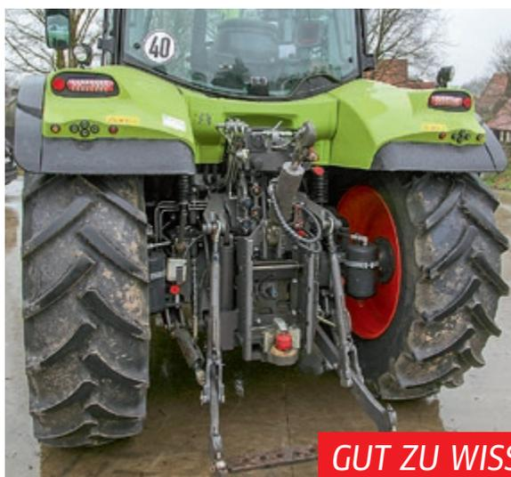
Bereits bei der ersten Generation war das Heck schon ziemlich komplett ausgestattet, lediglich beim „C“ (Foto links) fehlten z. B. die Entlastungshebel an den Ölschlüssen. Und die Hubkraft wurde 2013 bei allen Modellen einmal erhöht.
