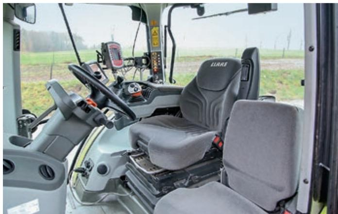
Die zweite Kabinengeneration (oben) wurde 2013 eingeführt – mit schlanker Lenkkonsole, neuer Bedienarmlehne und vielen verbesserten Details.
