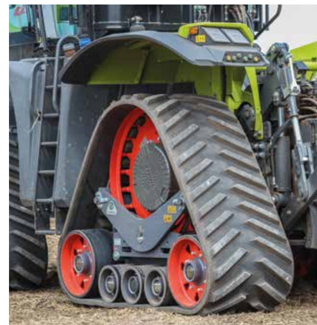
Alle vier Laufwerke zusammen kommen auf eine Bodenaufstandsfläche von 4,72 m 2 – das sind rund 25 % mehr als bei einer 900er und 35 % mehr als bei einer 750er Bereifung.
