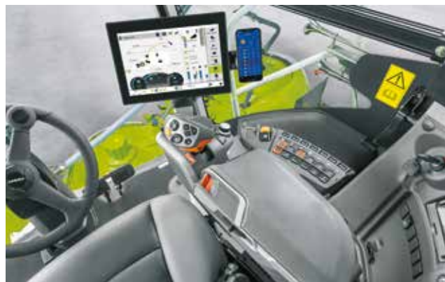
Das CEBIS Terminal mit Touch-Funktion gehört zur Grundausrüstung der neuen JAGUAR 900 und 800.
