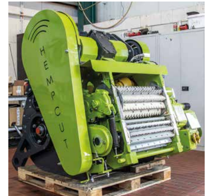
Der HEMP CUT für die Hanfstängelernte mit dem JAGUAR ist ein spezielles Aggregat aus Vorgelege und Einmesser-trommel.
