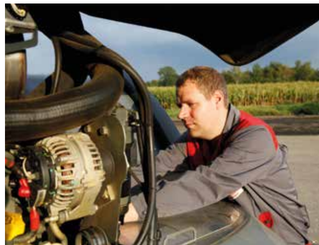
Sebastian Kuc von der Firma Fricke liest das elektronische Fehlerprotokoll der Maschine aus und wechselt schnell den defekten Sensor.
