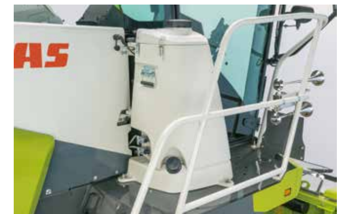
Dank Doppelwandisolierung hält der ACTISILER 37 die Siliermittelkonzentrate länger kühl.
