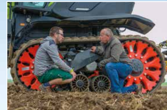
Landwirt Jürgen Harnisch (re.) und Lukas Karras begutachten das TERRA TRAC Laufwerk. Für den Traktor wurde das hintere Antriebsrad vergrößert und die Getriebeeinheit verstärkt.
