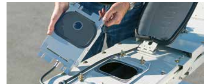
Der im JAGUAR verbaute NIR-Sensor sammelt in Mais und Gras zuverlässige Messdaten.
