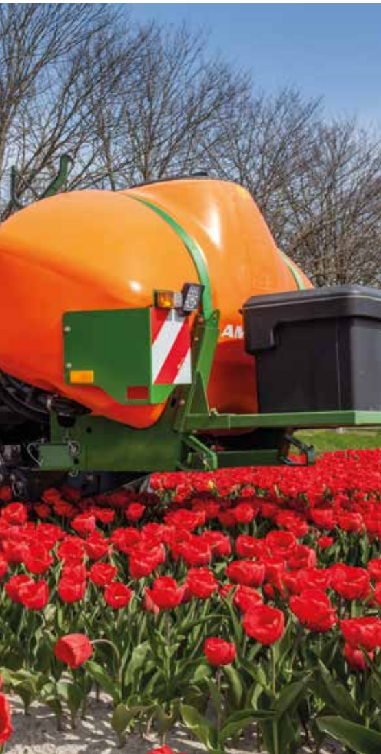
Rund 90 % der Blüten köpft dieser kleine, allradangetriebene Selbstfahrer, der Rest muss anschließend von Hand abgesammelt werden.
