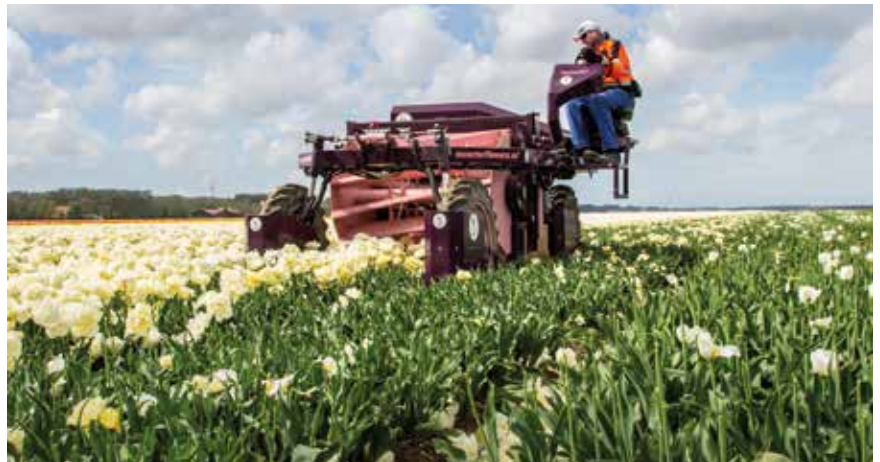
Rund 90 % der Blüten köpft dieser kleine, allradangetriebene Selbstfahrer, der Rest muss anschließend von Hand abgesammelt werden.
