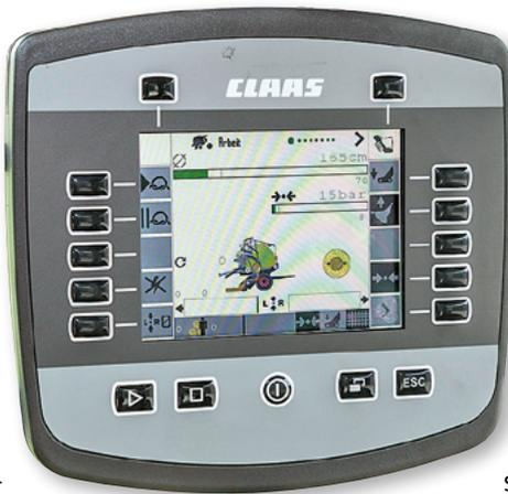
Mit dem Communicator-Bedienterminal ist die Bedienung einfach. Gut gefallen haben uns die gute Struktur und die klaren Symbole.
