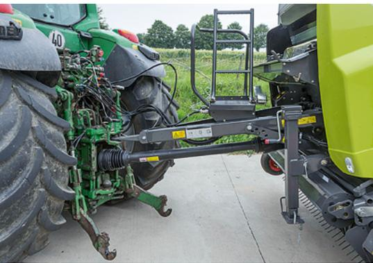
Die lange Deichsel ermöglicht weite Lenkeinschläge. Leider ist sie nicht ausreichend verstellbar.
