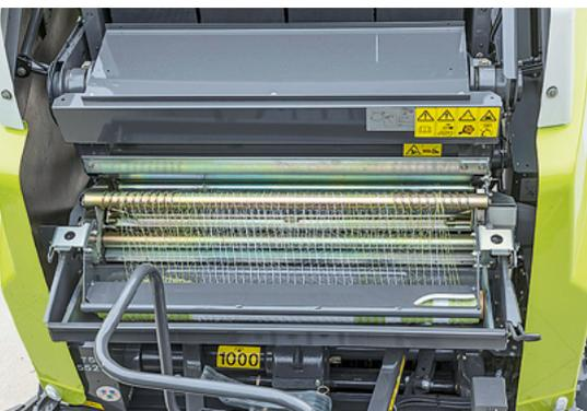
Die Bindung leistet hervorragende, zügige Arbeit und zieht das Netz dank der Spiralwelle auch auf die volle Ballenbreite.
