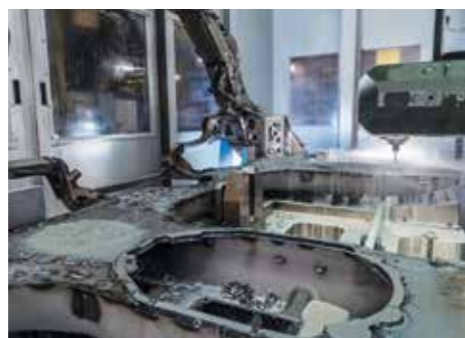
Die Mittelmulde und Ausleger vom ORBIS werden in einer Aufspannung exakt bearbeitet.
