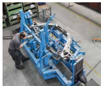
Vorbereitung der Einzelteile in einer Schweißvorrichtung zur Herstellung der Mittelmulde.
