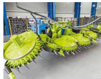
Mit dem neuen Prüfstand zur Montageendprüfung wird jede Funktion des ORBIS getestet.
