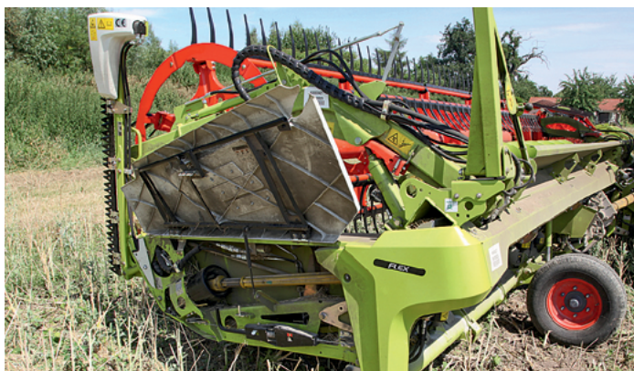
Die Seitenmesser (endlich mit Handgriff!) und den beidseitigen Messerantrieb ohne Riemen kennt man vom Vario-Schneidwerk. Darunter der werkzeuglose Bandspanner mit Indikator. Die Seitenklappen werden noch geändert.
