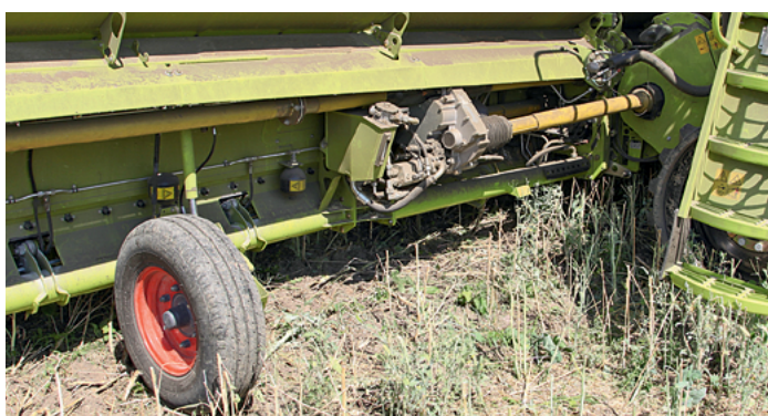
Die optionalen Tasteräder sind eher für hohe Fahrgeschwindigkeiten gedacht. An dem Hauptgetriebe sitzen bis zu drei Ölpumpen für die Seitenbänder und die optionale Querförderschnecke, das Mittenband sowie die Rapsmesser.
