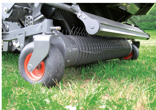
Die beidseitig gesteuerte Pick-up mit fünf Zinkenreihen ist hydraulisch angetrieben und nimmt das Futter sauber auf.
