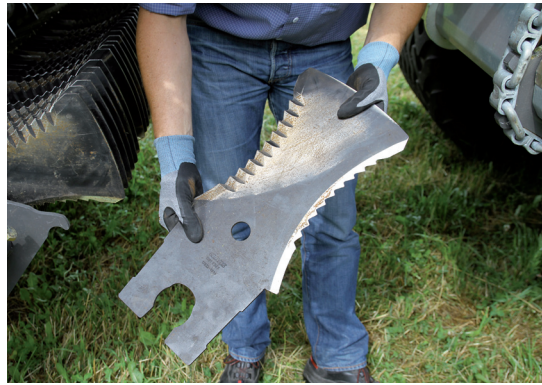
Die Schneidmesser lassen sich einfach ausbauen und können beidseitig verwendet werden.
