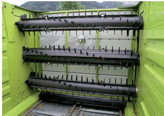
Die drei Dosierwalzen leisten gute Arbeit. Der Ultraschallsensor zeigt am Terminal immer den Füllstand des Wagens an.
