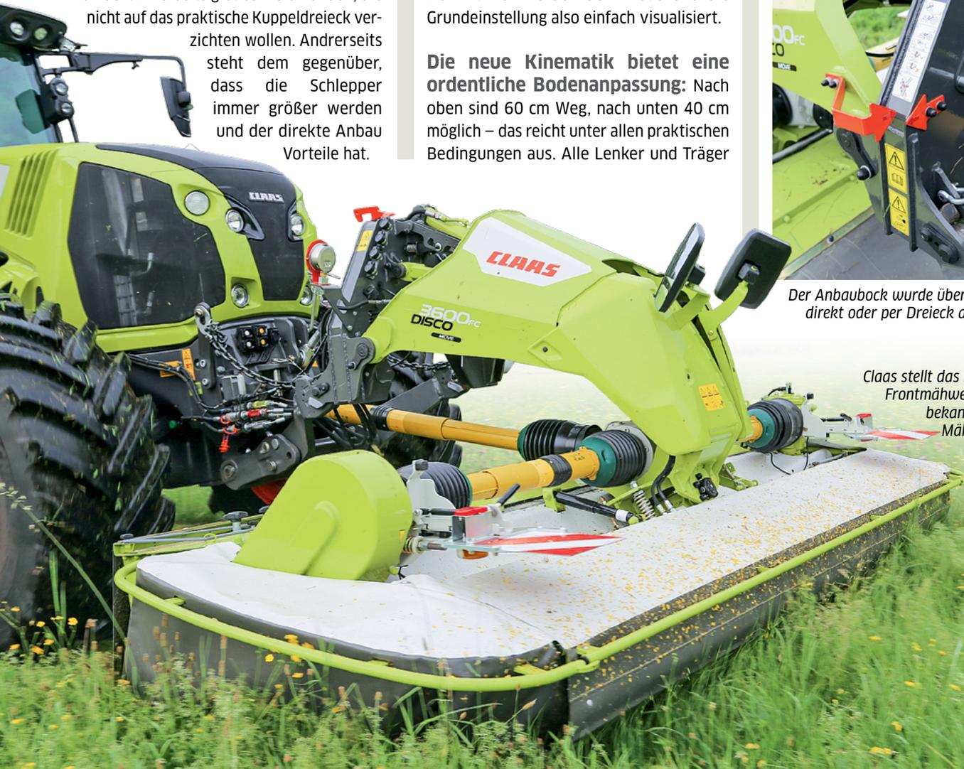
befinden sich unter der als tragendem Bauteil designten Haube. Pendelbewegungen zur Seite und nach hinten ermöglicht der um 30° Grad schräg gestellte Tragebolzen.
