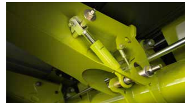
Das ACTIVE FLOAT System entlastet über kleine Hydraulikzylinder unter den Tragarmen aktiv den Messerbalken.
