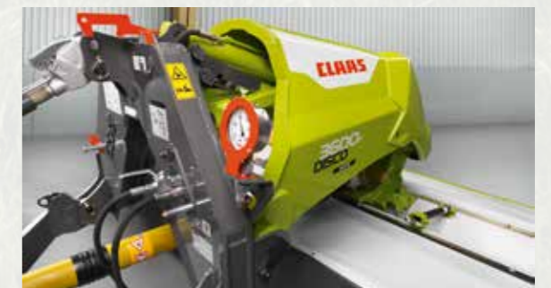
Der MOVE Anbaurahmen zeichnet sich durch eine kompakte Bauweise aus, die für den Fahrer eine gute Übersicht nach vorne ermöglicht.
