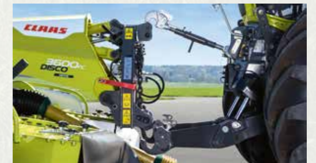
Einfacher Anbau, wahlweise über Weiste-Dreieck oder als Direktanbau über Dreipunkt.
