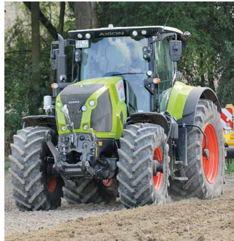
Für den Betrieb der Reifendruckregelanlage sind ausschließlich schlauchlose Radialreifen zu verwenden.
