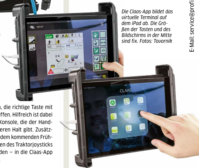
Die Halterung mit dem „Claas Wireless Interface“. Das blaue Kabel führt zur ISO-Bus-Dose des Traktors, das weiße lädt das iPad, die Kommunikation ist drahtlos.
