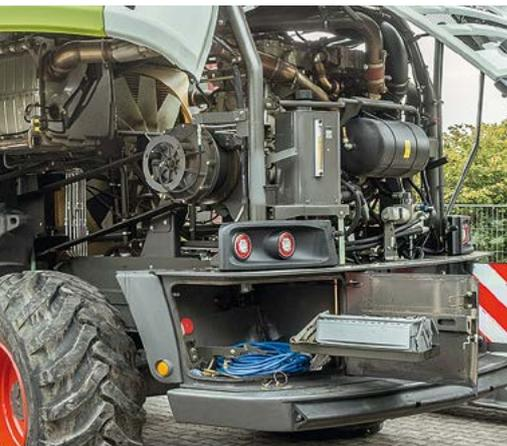
Hinten links hinter einer Klappe findet sich ein großzügiges Fach für Werkzeug.
