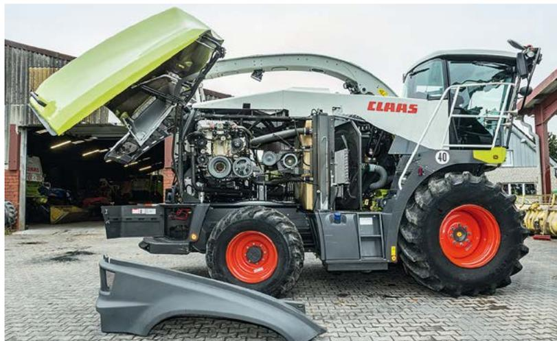
Zur Wartung sind alle Baugruppen gut zugänglich. Für größere Arbeiten ist die rechte Seitenklappe komplett aufschwenkbar. Prima auch die Druckluftanlage mit Anschlüssen zur Reinigung zwischendurch.
