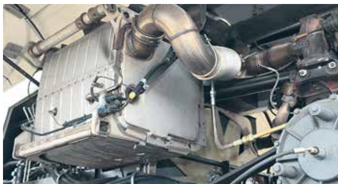
Die Tier4 i-Modelle haben einen entsprechenden SCR-Kat installiert. Das AdBlue wird bei einer Abgastemperatur von 260 °C eingespritzt.
