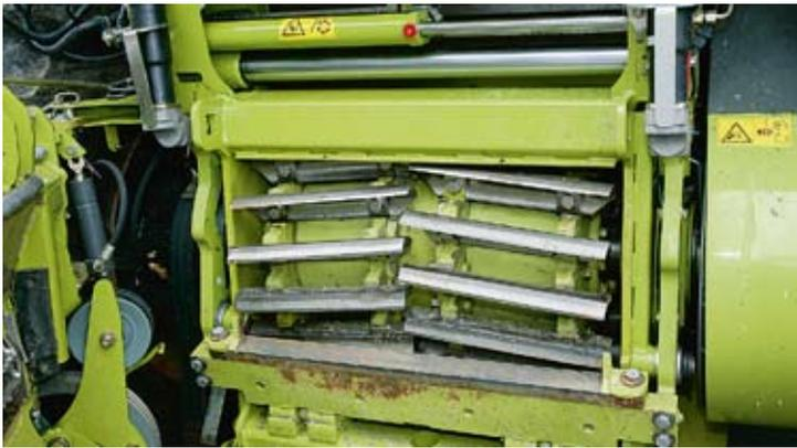
Die neue, mit einem Rohrkörper deutlich verstärkte „V-Max“-Trommel ist geschlossen. Im Jaguar 970 sind serienmäßig 36 (2 mal 18) Schaufelmesser V-förmig angeordnet.
