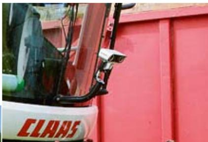
Beim Grashäckseln konnte die neue Pickup überzeugen. Auch die von der Kamera „Cam-Pilot“ (oben) gesteuerte automatische Lenkung mittig übers Schwad funktionierte tadellos.
