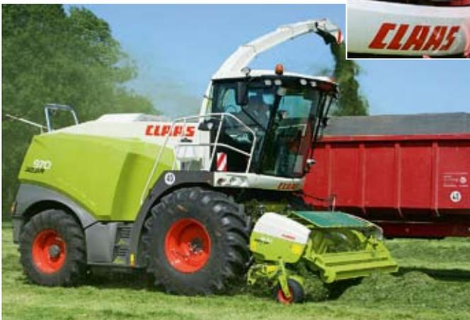
Wir sind beim Grashäckseln in der Regel mit 18 bis 20 mm Schnittlänge und meist nur mit einem Motor gefahren, dessen Drehzahl wir auf 1800 U/min begrenzt hatten. Denn auslasten kann man beide Motoren im Gras unter normalen Bedingungen kaum. Den Durchsatz und den Dieselverbrauch bei der Arbeit mit einem Motor/beiden Motoren zeigt die Tabelle „Gras-Durchsatz des Claas Jaguar 970“.
