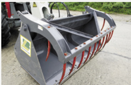
Die Schürfkante ist geschraubt, die Zinken sind verdrehgesichert.
