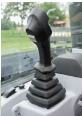
Statt die Zusatzhydraulik sollte die Wippe auf der Joystick-Rückseite die Wende- schaltung betätigen.
