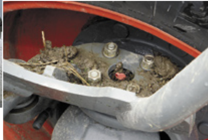
Die Schmiernippel sind zum Teil (Bild links über der Hinterachse) zu einem Pult zusammengefasst und gut erreichbar. Die zur Verschmutzung neigenden Nippel der Achsschenkel will Claas verbessern.
