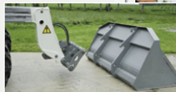
Die 1,8 m 3 große Universalschaufel von Kramer machte einen robusten Eindruck und ließ sich auch bei klebrigen Gütern gut leeren.
