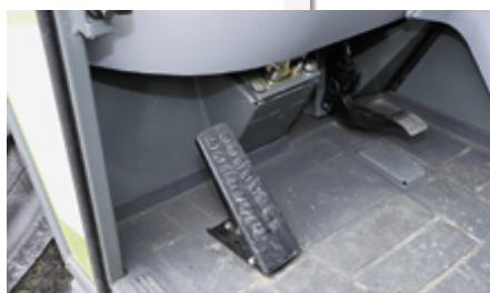
Für die intuitive Bedienung auf der Straße mit dem rechten Fuß sollte das Brems-/Inchpedal breiter sein.
