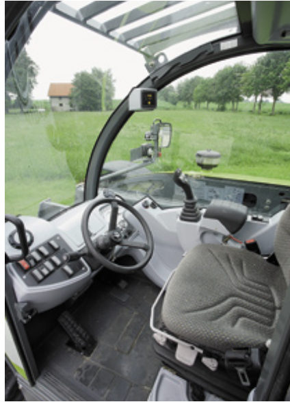
Dank luftgefedertem Sitz und zweifach verstellbarer Lenksäule finden nahezu alle Fahrer eine bequeme Arbeitsposition.
