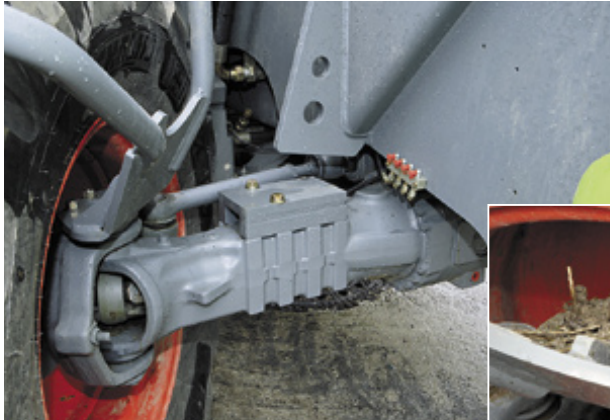
Die Schmiernippel sind zum Teil (Bild links über der Hinterachse) zu einem Pult zusammengefasst und gut erreichbar. Die zur Verschmutzung neigenden Nippel der Achsschenkel will Claas verbessern.
