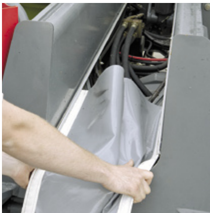
Die Plane deckt den Bereich unter dem Telearm gut ab, ihre Montage ist z.B. nach Wartungsarbeiten nicht ganz einfach.
