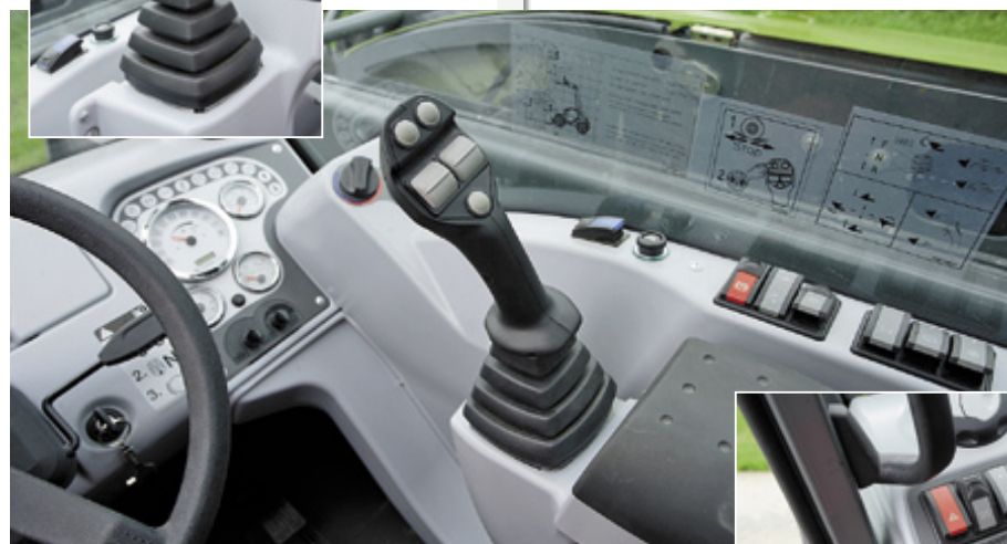
Der Multifunktionshebel ist mit seiner Konsole verstellbar am Fahrersitz montiert. Er liegt gut in der Hand und erlaubt eine feinfühligere Bedienung.
