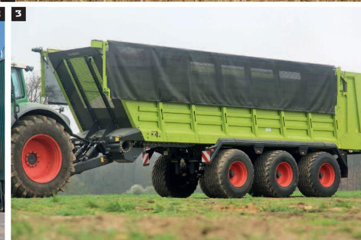
1 Die hydraulisch klappbare Laderaumabdeckung ist für beide Fahrzeugvarianten optional erhältlich.
