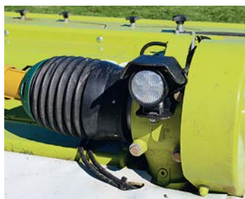
Die Schnellverschlüsse der Gelenkwellenschutze erleichtern die Wartung.
