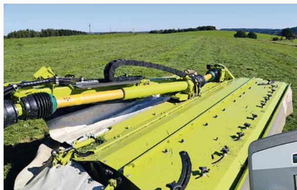
Sofort fällt das Antriebskonzept auf, das die Kraft zunächst über das Mähwerk hinwegführt.
