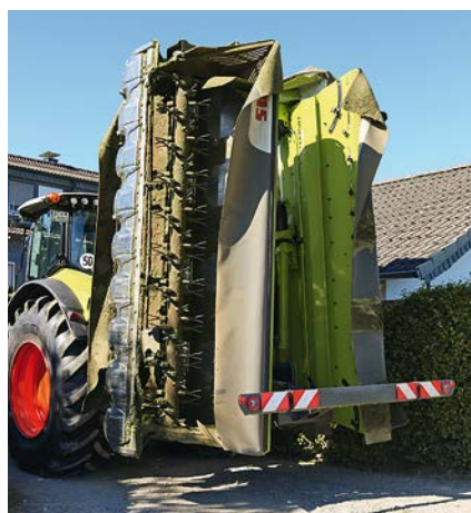
Dank der hydraulisch klappenden Schutze (außen und innen!) und der Teleskopfunktion klappt das Mähwerk kompakt zusammen.
