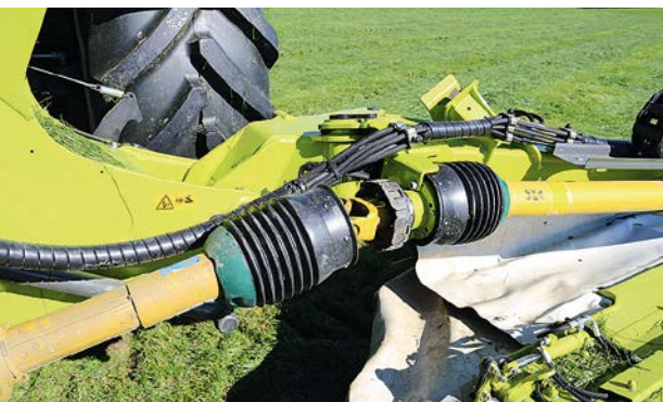
Die Schnellverschlüsse der Gelenkwellenschutze erleichtern die Wartung.
