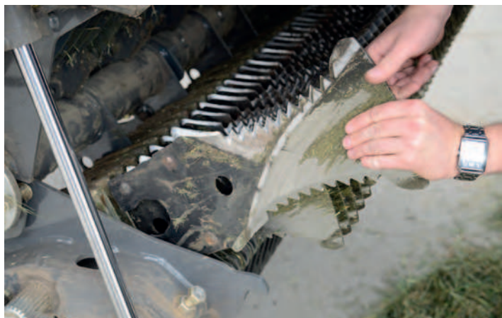
Die neuen Messer verfügen über zwei Schneiden. Entsprechend können sie gedreht und die Einsatzzeit pro Messersatz verdoppelt werden.
