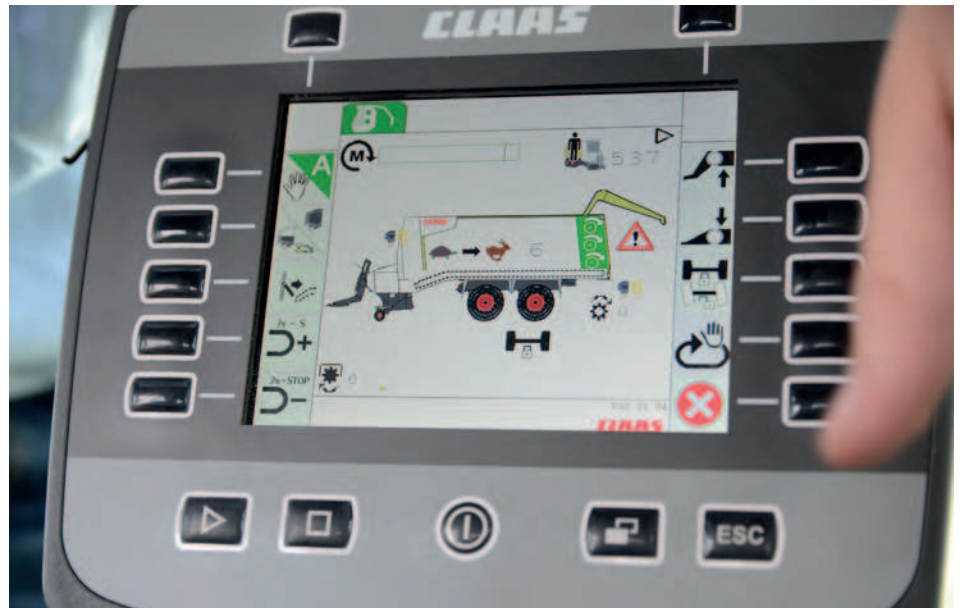
Über das Bedienterminal (hier der Communicator 2) wird der Cargos 8000 gesteuert. Darüber kann der Fahrer unter anderem die Befüll- und Abladeautomatik des Ladewagens programmieren.
