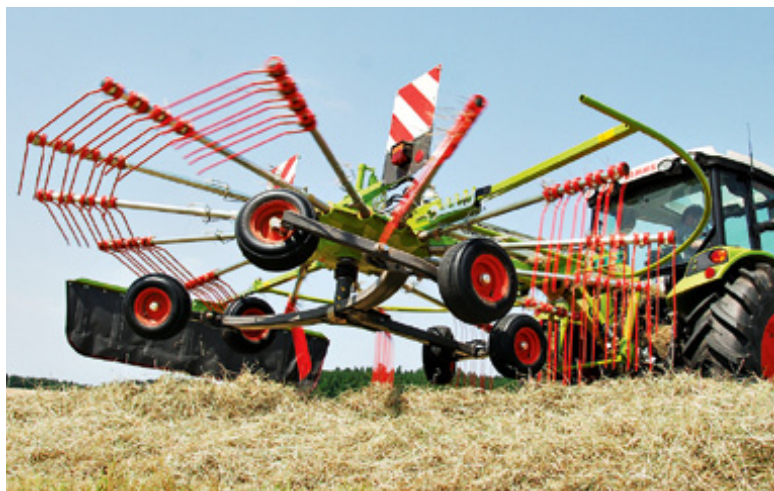
Die kardanische Aufhängung im Zentrum des Kreisels verbessert die Boden Anpassung und bringt die nötige Aushubhöhe am Vorgewende.
