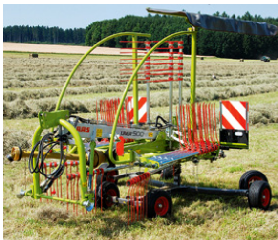
In weniger als drei Minuten fertig zum Transport: Die Zinkenräger lassen sich an den Seiten bequem parken.
