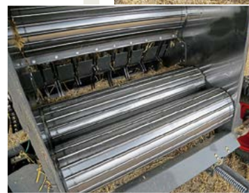
Die Pickup misst 2,10 m. Der Rotor hat einen Durchmesser von 500 mm. Sieben Messer schneiden das Pressgut auf theoretisch 152 mm.
