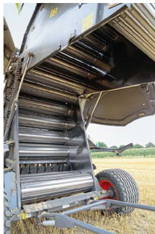
Die Presskammer hat 17 Walzen, die grundlegend überarbeitet wurden. Die Materialstärke beträgt 4 mm, die Lager sind einfach tauschbar.
