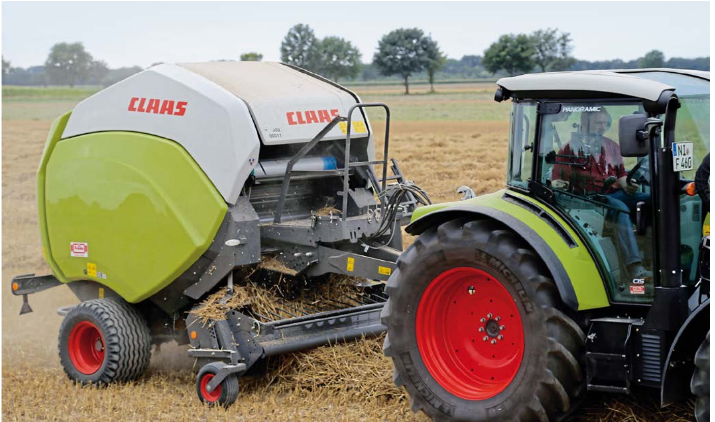
Eine einfache Maschine für den Einstieg in das Rundballengeschäft: Wir haben die 620 RC mit Sieben-Messer-Schneidwerk bereits gefahren.
