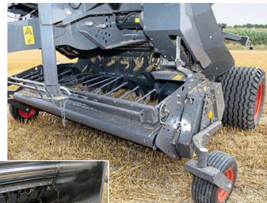
Die Pickup misst 2,10 m. Der Rotor hat einen Durchmesser von 500 mm. Sieben Messer schneiden das Pressgut auf theoretisch 152 mm.
