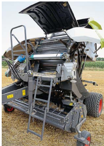
Die Bindung hat einen guten Aufstieg, ein großzügiges Podest, und das Netz kann aus der Schurre (links) gut nachgelegt werden.
