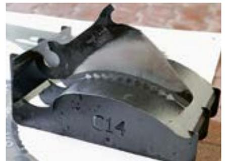
*Die Schablonen sind sicher gekennzeichnet. Unabhängig vom Verschleißzustand der Messer wird die Schneide konturgetreu und mit gleichbleibendem Winkel geschliffen.*
