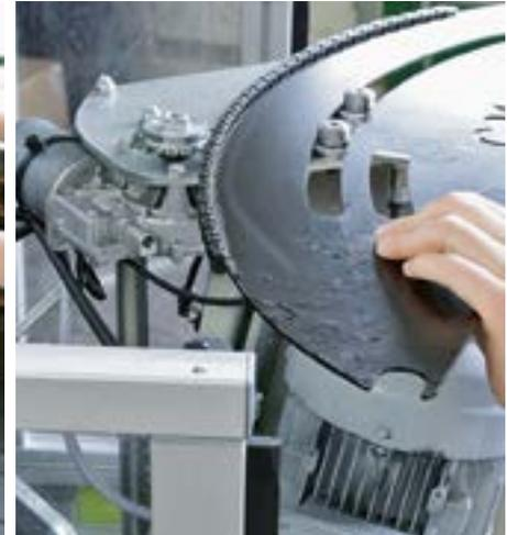
*Mit über 90 Schablonen sind fast alle Ladewagen- und Pressenmesser auf dem Markt zu schleifen. Der dreigelenkige Arm samt E-Motor mit Schleifscheibe wird mit dem Ritzel entlang der vorgegebenen Kontur geführt. Ein Sensor erkennt anhand der ausgelaserten Bögen, wann die Topfscheibe ausgehoben und die Richtung gewechselt werden muss. Fotos: Bensing*
