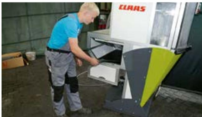
Die geschliffenen Messer werden in der hinteren Ablage entnommen, gestapelt werden sie allerdings nicht.
