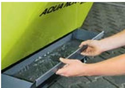
Der Schleifabtrag wird unten in einer Schublade gesammelt und kann dann entsorgt werden – saubere Sache.
