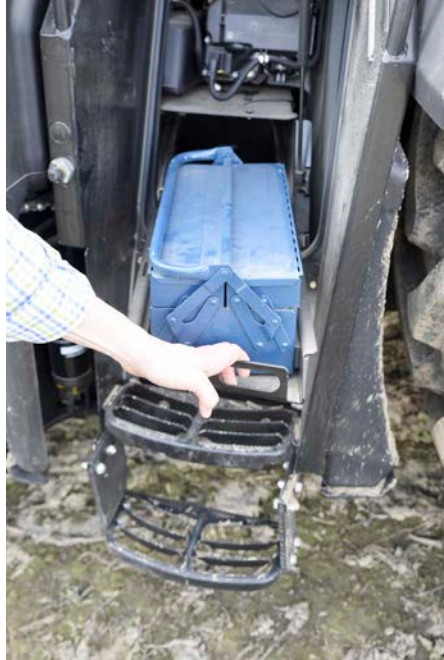
Unter dem Aufstieg links befindet sich ausreichend Platz für eine Werkzeugkiste. Außerdem ist dort ein Druckluftanschluss montiert.
