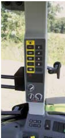
Die Vorwahl der Zapfwellengeschwindigkeit und die Einstellungen des Hubwerks liegen gut erreichbar auf der B-Säule.
