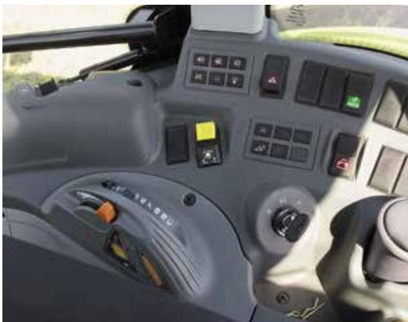
Die Hubwerk-Bedienung ist gut. Es fehlen allerdings Tasten zum Wechseln der Lastschaltstufen.
