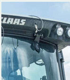
Das GPS-Kabel ist frei zur Antenne verlegt.
