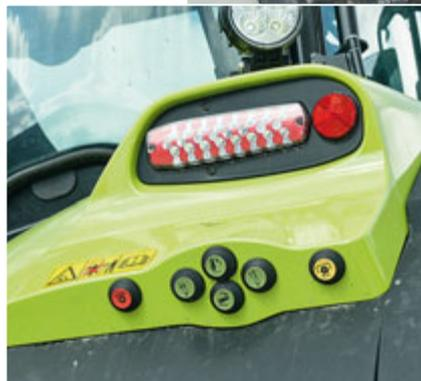
Links und rechts alles da: die Bedienung für Hubwerk, Zapfwelle und frei wählbares Ventil.
