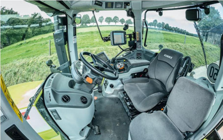
Die Kabine ist geräumig, komfortabel und mit 72,7 dB(A) schön leise. Das separate Terminal braucht man für das Lenksystem und ISO-Bus-Geräte.
