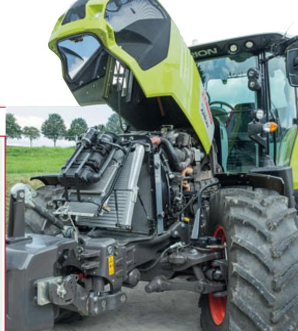
Der Sechszylinder von Deere Power Systems kommt noch ohne AdBlue aus, verbraucht aber in Kombination mit dem stufenlosen Getriebe gut 7 % mehr Diesel als der Schalter.
