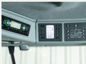
Gut erreichbar im Dach die Bedienung von Radio, Klima und Licht.
