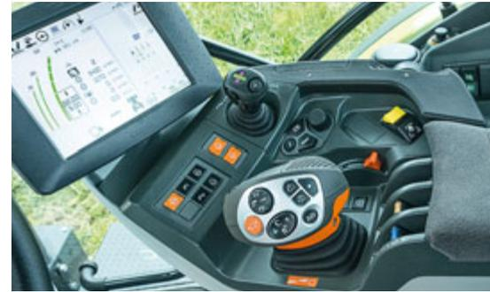
Die Ausstattung mit stufenlosem Getriebe erkennt man im Terminal (leider kein Touch) an den drei Geschwindigkeitsbereichen und an dem Wendeschaltknopf im Fahrhebel.
