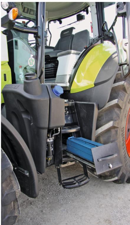
Kraftstoff- und AdBlue-Tank sind ausreichend groß dimensioniert. Praktisches Detail: In einem Schubfach in der Treppe versteckt sich eine Werkzeugkiste und ein Druckluftanschluss.
