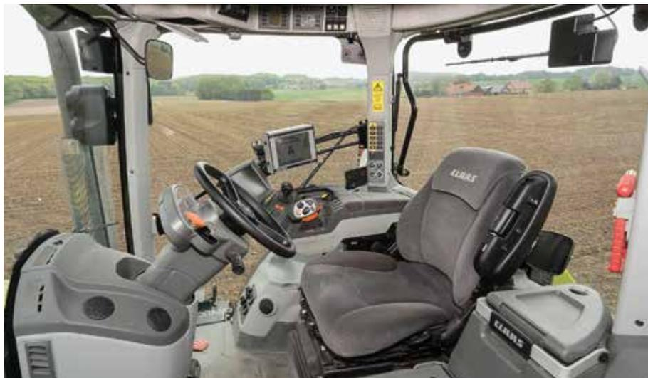
Die neue Vier-Pfosten-Kabine bietet eine sehr gute Rundumsicht und ist mit 75,7 dB(A) nicht zu laut. Es störten allerdings die Getriebe- und Sitzgeräusche.
