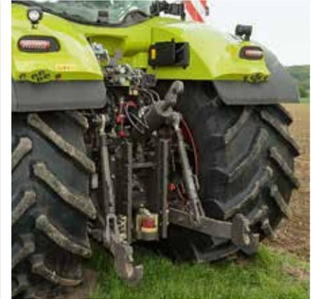
*Mit 8 t Hubkraft fehlt es in dem sehr aufgeräumten Heck an nichts. Der hydraulische Kat. IV-Oberlenker ist alleine aber kaum zu bändigen.*
