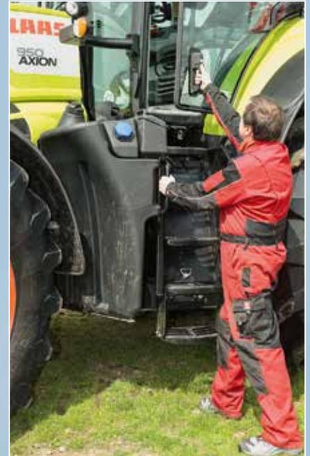
*Jeder kommt an den Türgriff, der Handlauf links könnte aber bei sechs (!) Trittstufen noch höher reichen. 700 l gehen in den Dieseltank und auch der Werkzeugkasten sitzt an der richtigen Stelle.*
