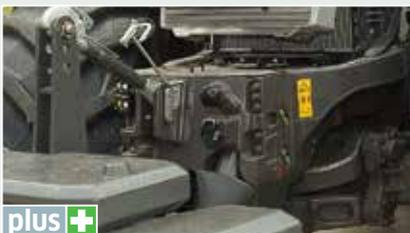
Außer dem Hubwerk kann man auch vorne eins der zwei Ventile extern bedienen – und natürlich gibt es eine Licht- und eine ISO-Bus-Steckdose!
