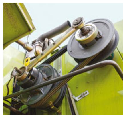
Der Rotorvariator ersetzt den alten Stufenantrieb der Restkornabscheidung.
