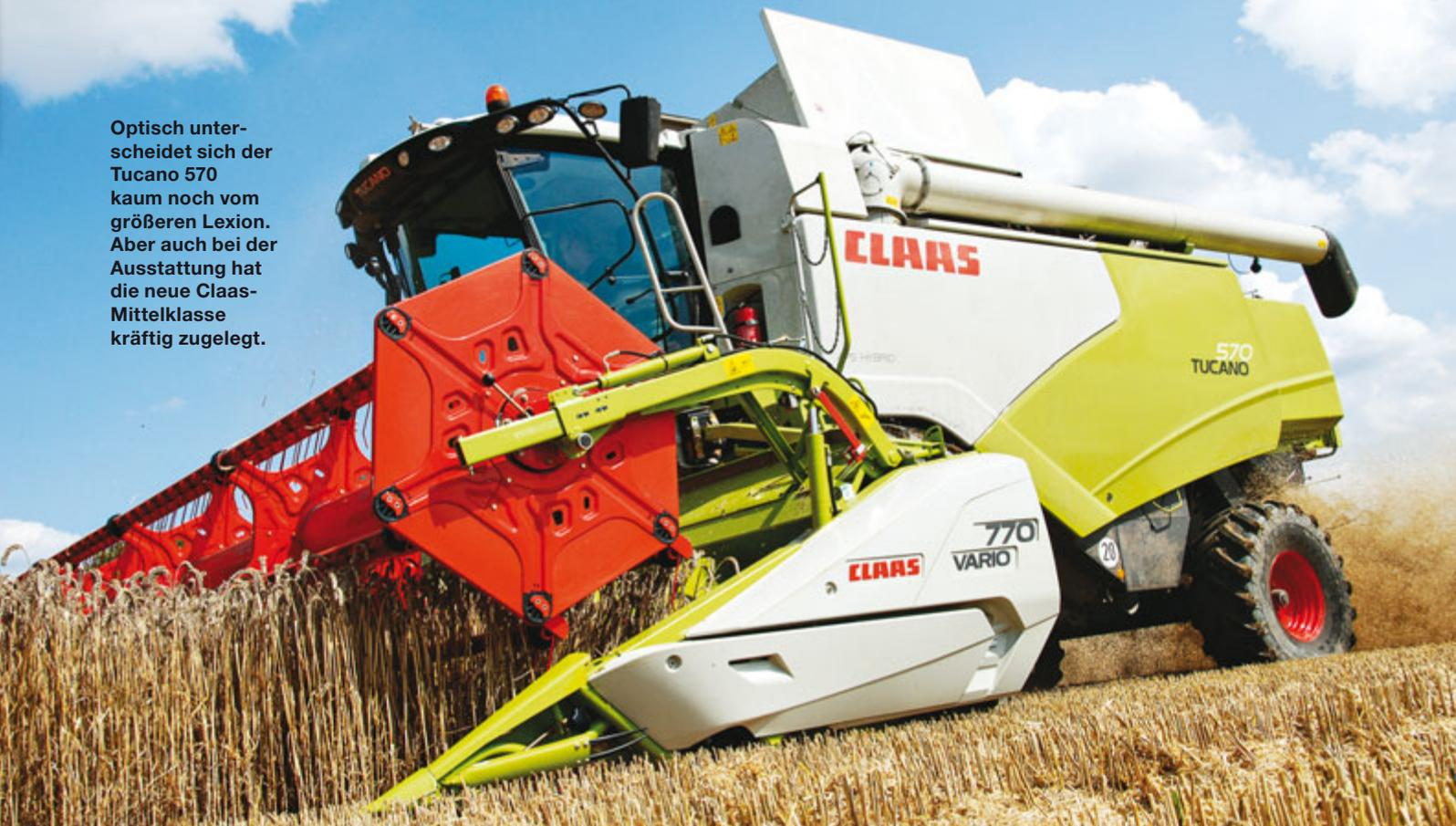
Musste der Häcksler beim Vorgänger noch mit einer mechanischen Kuppelung zu- oder abgeschaltet werden, geschieht dies beim neuen Tucano automatisch beim Umlegen des Strohleitbleches auf der linken Maschinenseite.
