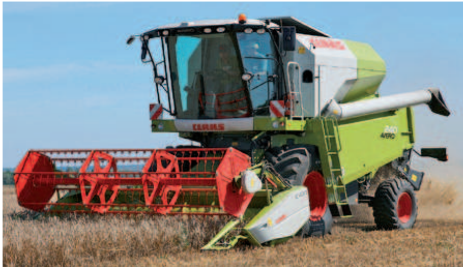
Der neue Claas Avero mit vier Schüttlern und APS-Dreschwerk passt genau zwischen den Dominator 150 und den Tucano 320. Fotos: Eikel
