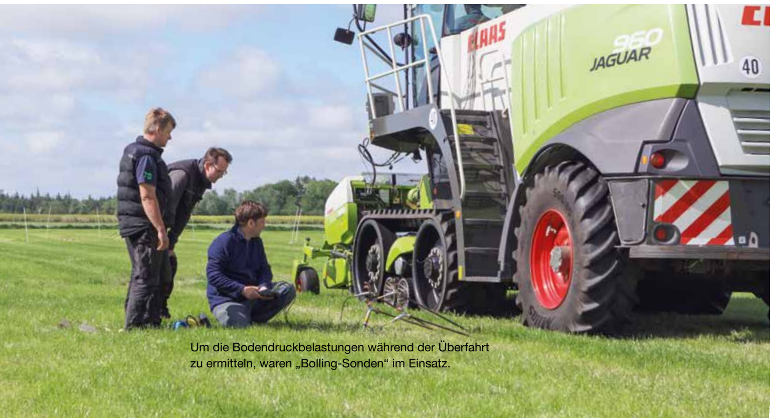
Abb. 3: Bodendruckmessung bei Kurvenfahrt (Radmaschine)
