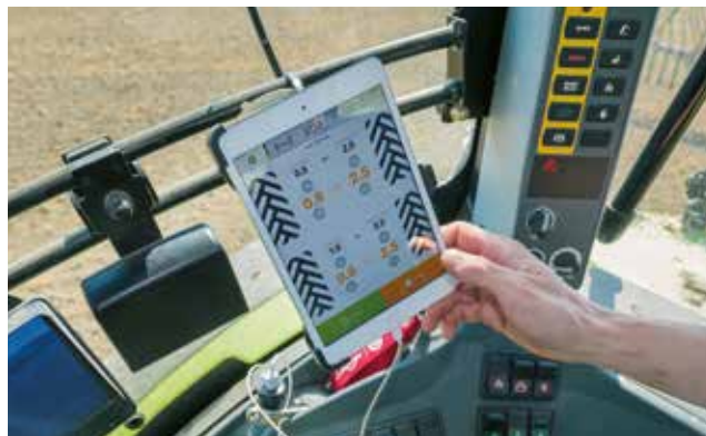
Die Bedienung der Reifendruckregelanlage erfolgt über ein iPad.
