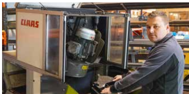
Das Messerschleifgerät AQUA NON STOP sorgt auch in der Saison schnell für scharfe Messer.
