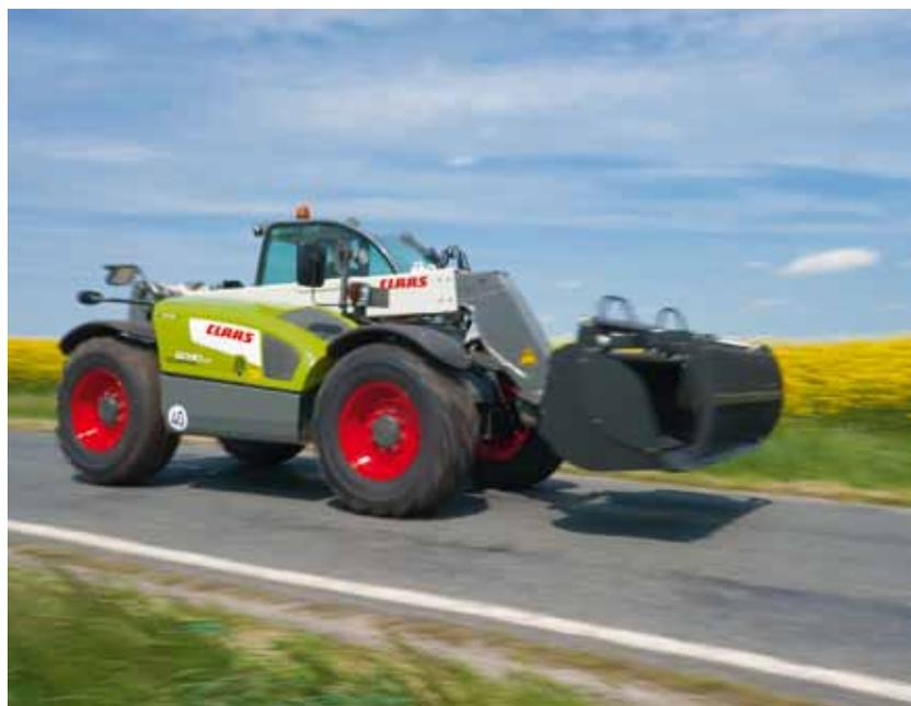
Der SCORPION hat als Antrieb einen Großwinkel-Hydrostaten, mit dem die Maschine ohne zusätzliche Schaltstufe von 0 bis 40 km/h stufenlos fahren kann. Im Antrieb ist also nur eine Zahnradpaarung für das Verhältnis Schubkraft/Geschwindigkeit verantwortlich. Das bietet CLAAS die Möglichkeit, den Antrieb für bestimmte Anwendungsgebiete zu modifizieren.
