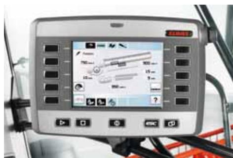
CEMOS AUTOMATIC erfasst mit zahlreichen Sensoren sekundengenau verschiedenste Parameter des Mähdreschers und passt ohne Zeitverlust die Einstellungen den aktuellen Gegebenheiten an – völlig selbstständig und voll automatisch. In Kombination mit der automatischen Lenkung GPS PILOT und dem Durchsatzregler CRUISE PILOT erreicht CLAAS so die nahezu vollautomatische Getreideernte.
