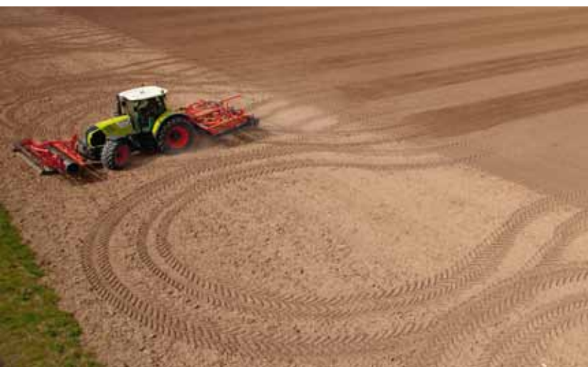
Die Zusatzfunktion AUTO TURN ermöglicht ein zügiges Wenden am Vorgewende mitsamt automatischer Führung in die nächste Spur.
