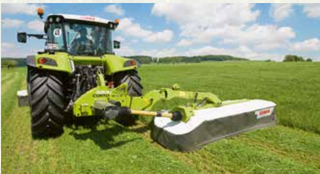
Gut erkennbar; die Schwerpunktaufhängung führt das Mähwerk ideal.
