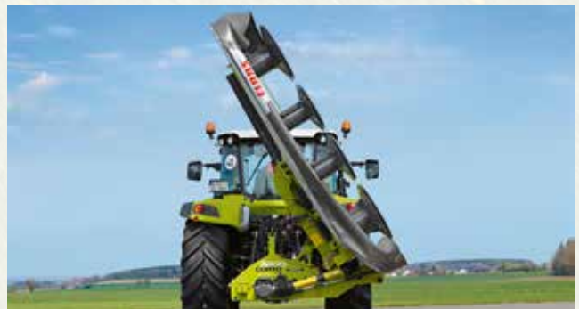
Das neue CORTO 3200 CONTOUR wird in einer 120° Klappposition gefahren.
