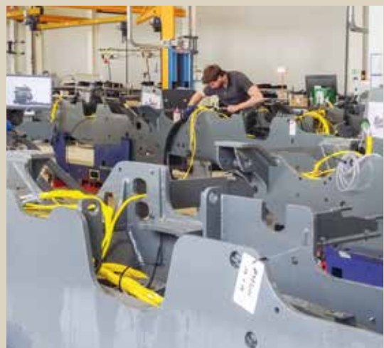
Mit dem Abstellen der Chassis auf die fahrbaren Gestelle beginnt die Montage.
