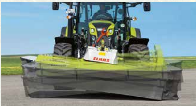
Das CORTO 310 F kann sich in Quer- wie auch in Längsrichtung anpassen.
