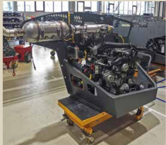
Die 4-Zylinder-Deutz-Motoren stellen je nach Modell 136 oder 156 PS für Hub- und Schubarbeiten zur Verfügung.
