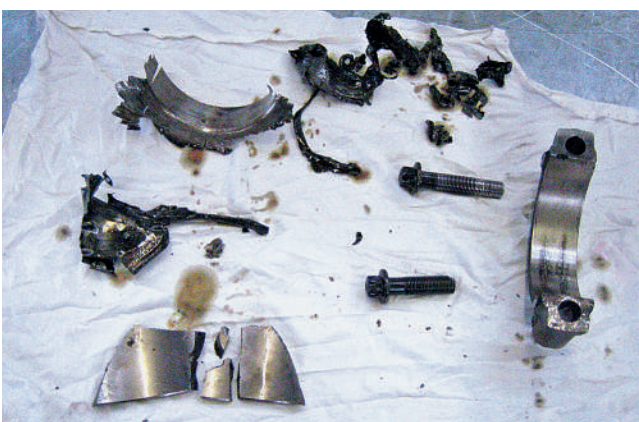
Palier de bielle usé avec éclats de la chemise de cylindre.
