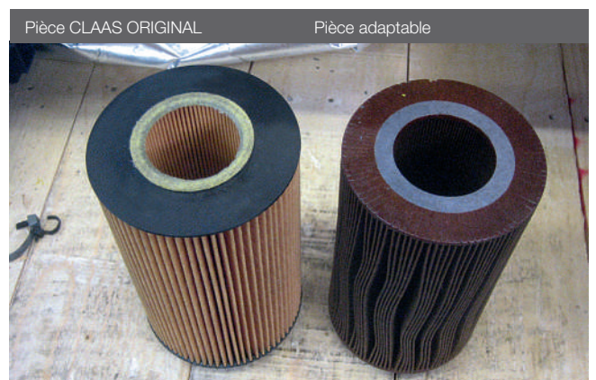
À gauche, un filtre CLAAS ORIGINAL neuf, à droite, une pièce adaptable endommagée (durée d'utilisation : 20 h). Si l'on compare les deux filtres, on peut voir que la pièce adaptable ne possède pas de joint. Il en résulte des fuites intérieures indétectables de l'extérieur lorsque le moteur tourne étant donné que le niveau de pression d'huile est maintenu. Résultat : des paquets de lamelles se forment sur le papier filtre, ce qui peut entraîner une sursaturation.
