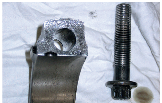
Chapeau de palier de bielle avec surfaces de fracture endommagées.
